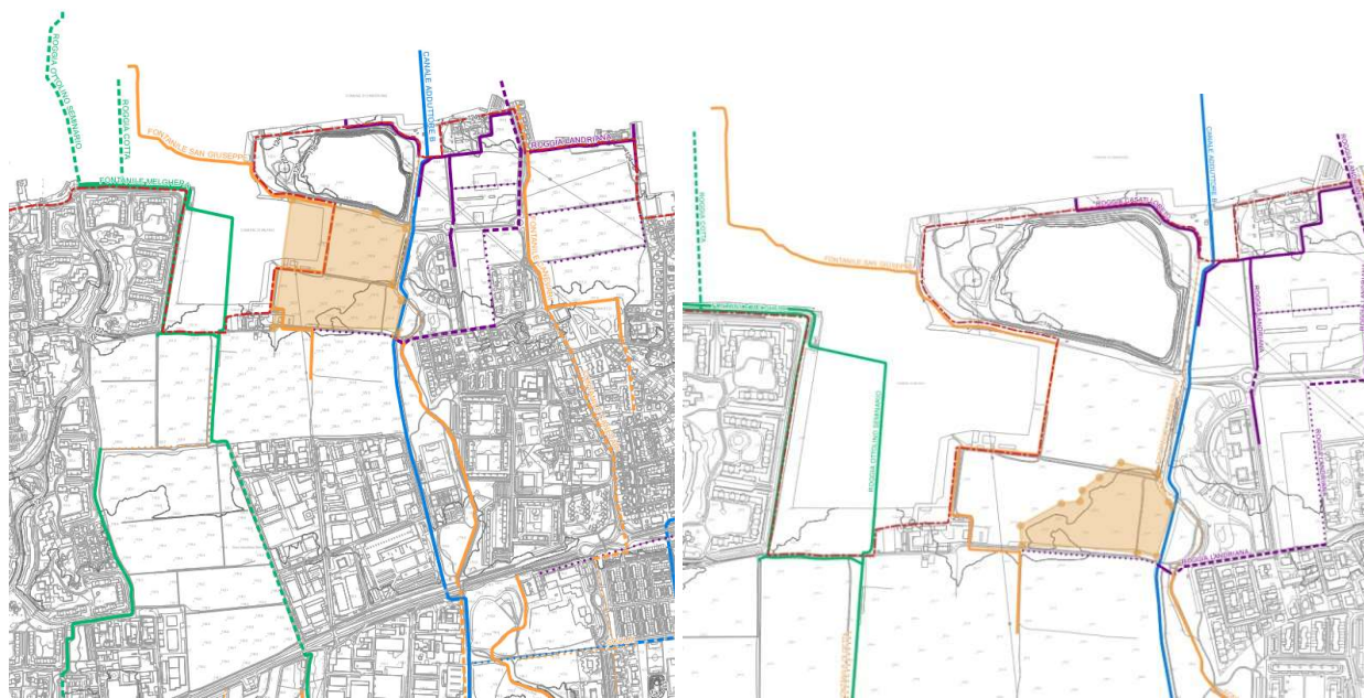
Figura 6: individuazione area A2 a sx e parte della stessa in cui si ha accumulo prima della tracimazione a 122,1 mslm sulla via Olgetta
