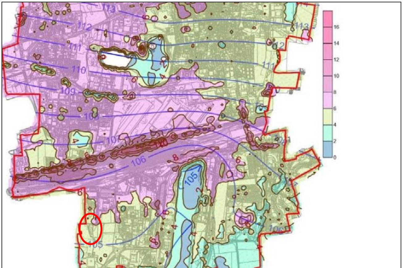
Figura 11: Soggiacenza della superficie piezometrica (Fonte: Componente Geologica del PGT di Segrate)
