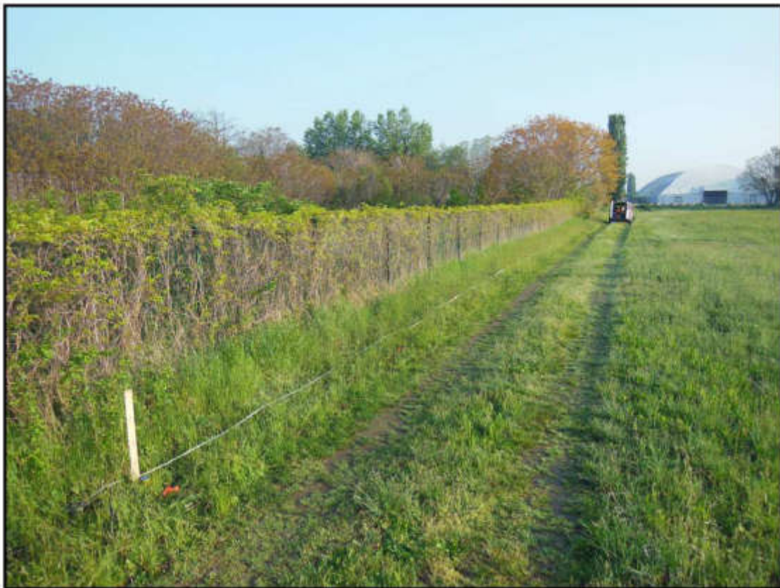
Figura 1: Stendimento sismico con interasse 4 metri.
