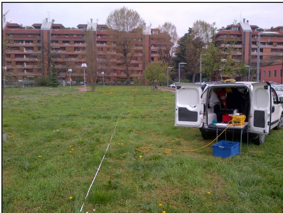
Figura 10.3: Vista dello stendimento MASW 2 – Area A2
