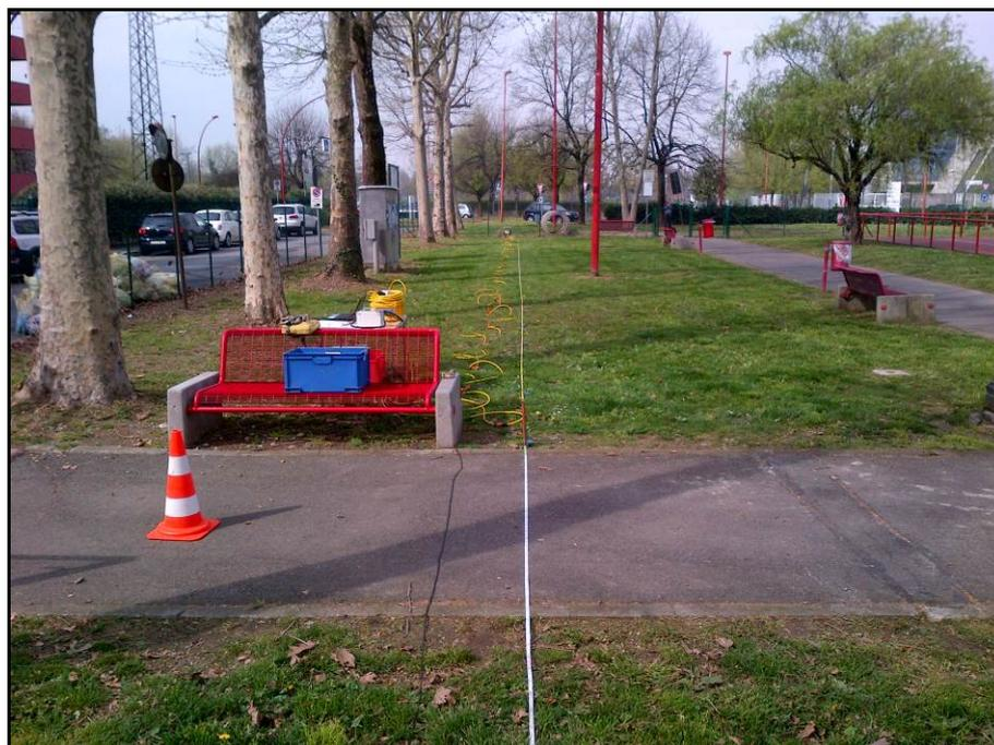
Figura 10.2: Vista dello stendimento MASW 1 – Area A1
