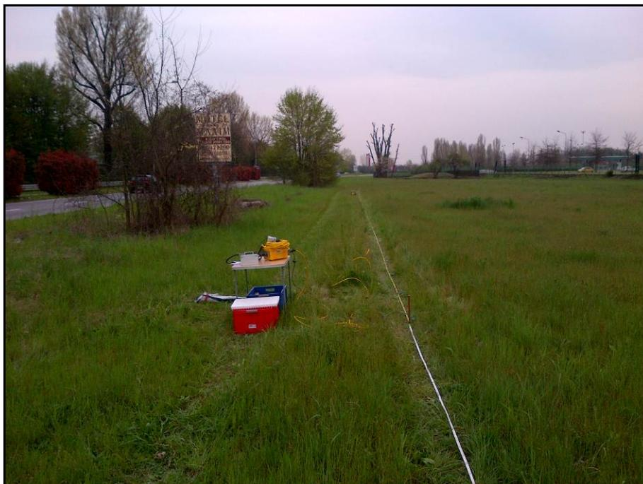
Figura 10.5: Vista dello stendimento MASW 4 – Area A4
