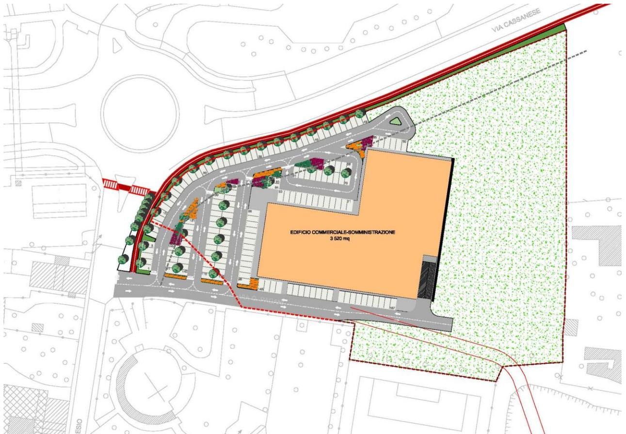
Figura 9: planimetria di progetto in scala 1:1000 con, in tratteggio nero la fascia di rispetto stradale.
