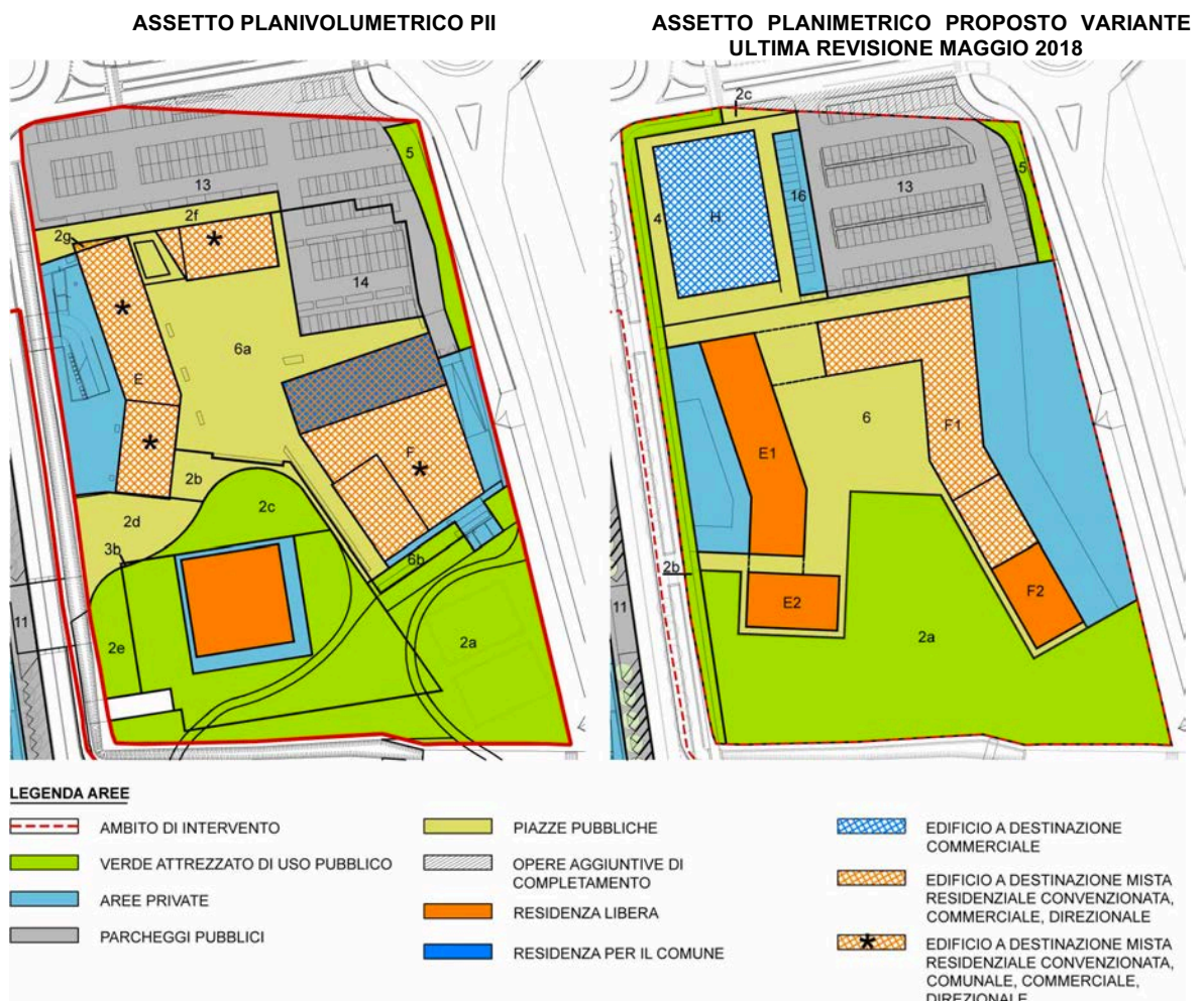
Figura 5-2 | Lotto 2: Confronto tra la planimetria di PII e variante ultima revisione maggio 2018.
