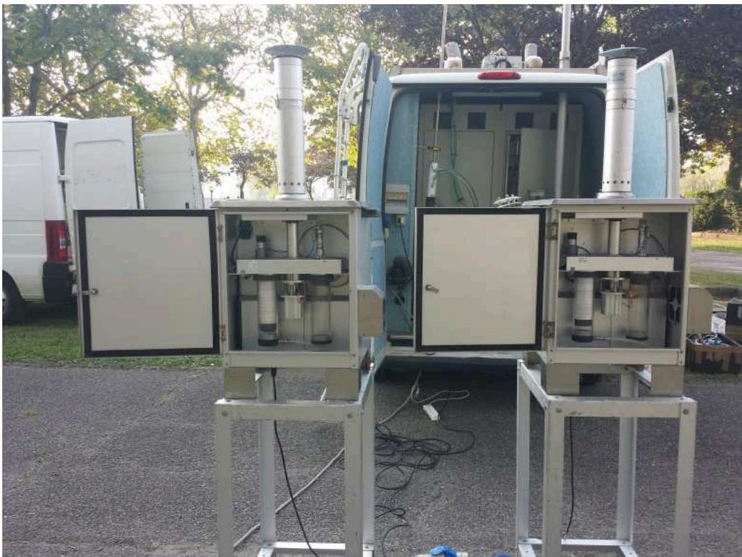
Figura 3 Analizzatori di inquinanti gassosi e di polveri (all'esterno del mezzo mobile)
