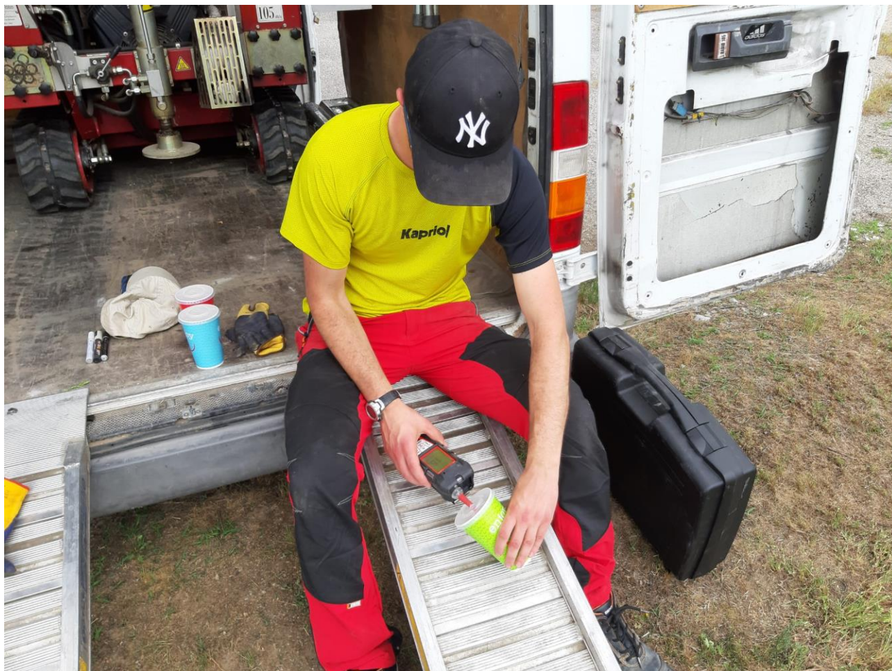
Figura 3 Misurazione con PID
