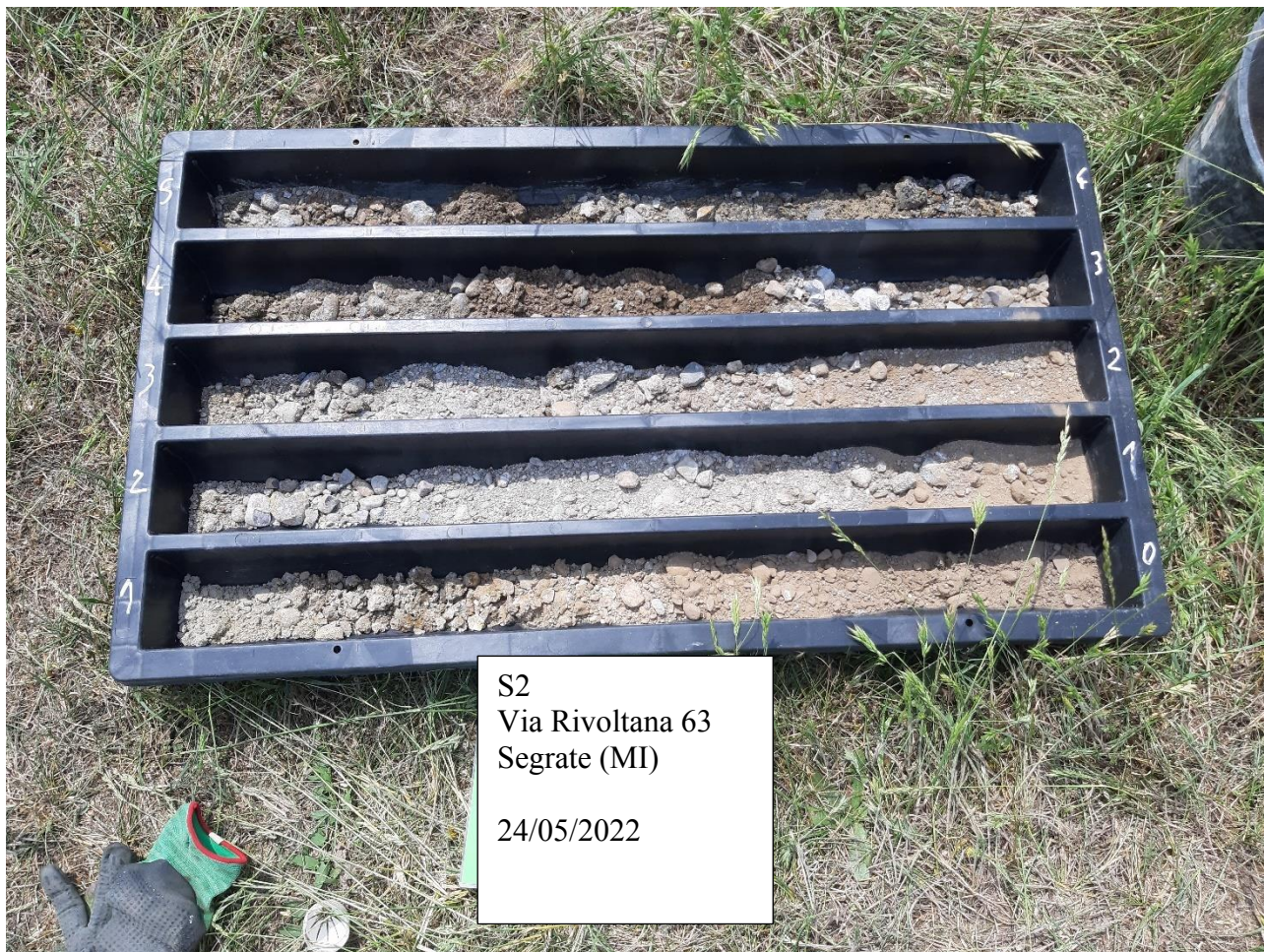
Figura 57 Cassetta sondaggio S2
