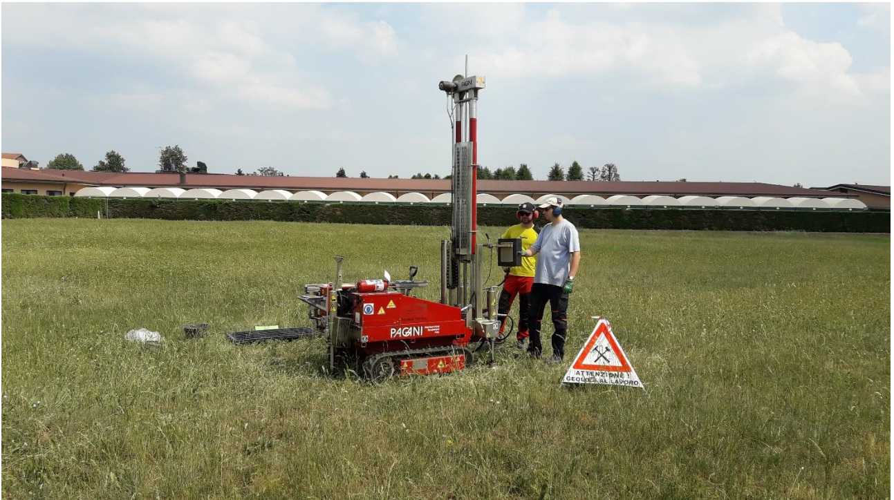
Figura 1 Campionamento a percussione con Pagani Tg 63-100
