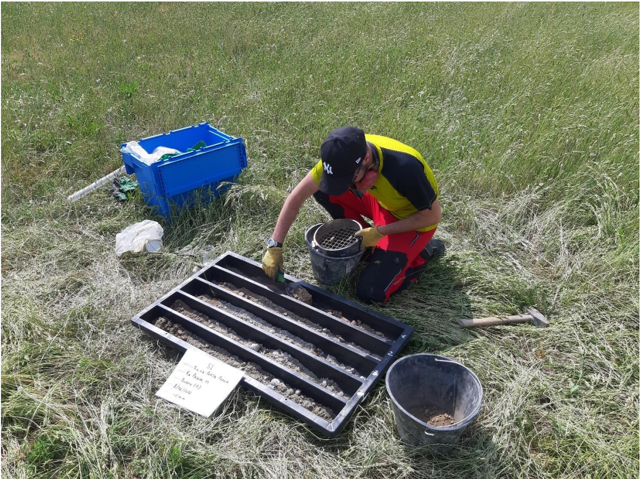
Figura 2 Campionamento con setacciatura
