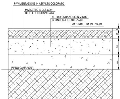
**DETAGLIO 3 - PAVIMENTAZIONE MARCIAPIEDE IN ASFALTO**
