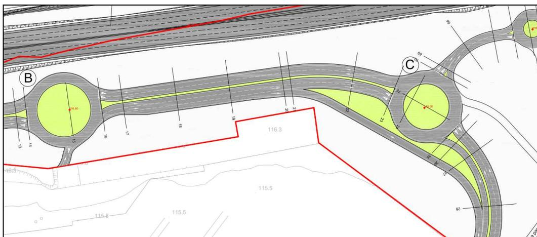
Una seconda rotatoria, anch'essa dotata di rampa diretta di svolta a destra continua, consente sia l'inversione di marcia per l'accesso ai parcheggi multipiano afferenti alla carreggiata opposta, sia il collegamento all'area di servizio carburanti e stazionamento bus.
