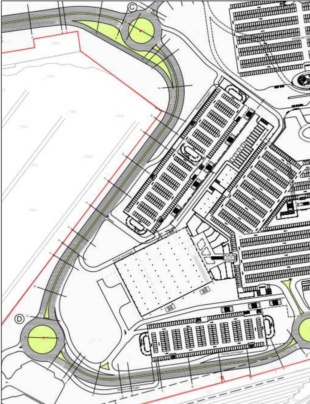
Lungo la viabilità che si sviluppa lungo il fronte sud sono previste rampe di collegamento ai parcheggi multipiano e una rotonda intermedia con funzione di collegamento della viabilità di accesso alle aree interne.
